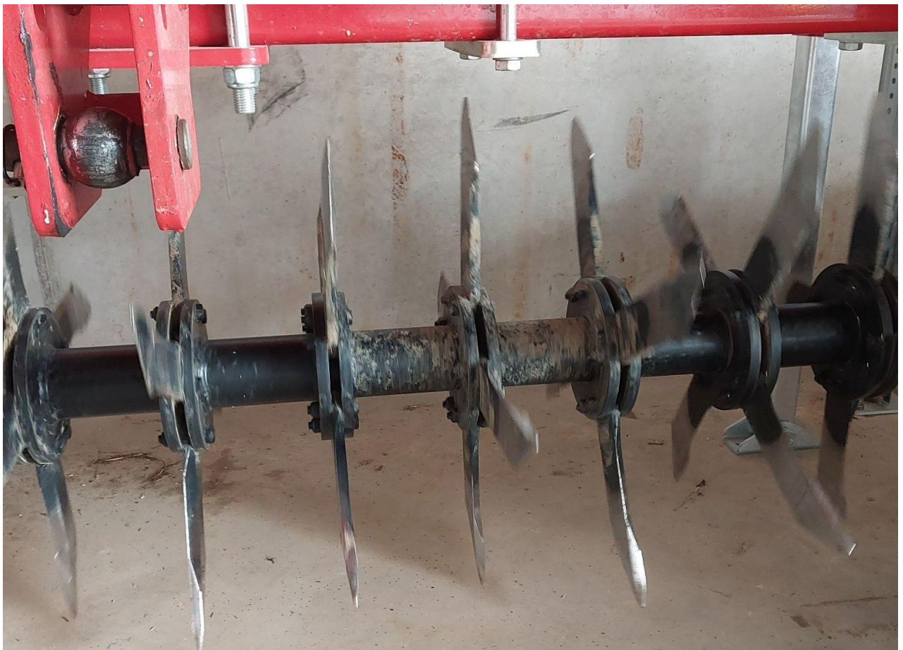
Abbildung 16: Maschinelle Bodenschlitzung zur Durchlüftung der oberen Bodenschichten und Förderung der mikrobiellen Tätigkeit. © Janet Maringer
